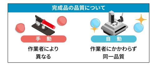
自動缶バッジマシンはプレス圧が一定のため、使用者が代わっても同じ品質の缶バッジを継続的に生産可能です。一方、手動缶バッジマシンでは、マシン使用者の力加減に依存するため、プレスが弱すぎたり、強すぎたりして製作に失敗する可能性があります。
