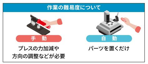
手動缶バッジマシンの場合、パーツを置いた後に自分の力を使ってプレスする必要があります。一方、自動缶バッジマシンでは基本的にはパーツを置くだけで、作業者の力を必要としません。作業者はデザインの向きやズレ、巻き込みのズレがないかどうかに集中できます。また、生産スピードやプレス圧も調整できるため、作業者の熟練度や使用する紙・フィルムに細かく合わせることが可能です。特にデザインを印刷する紙は、缶バッジ事業者それぞれで最適なものがあり、こだわりのポイントでもあります。
